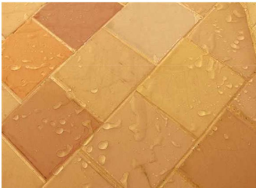
Al termine delle operazioni, si potrà versare acqua sulla pavimentazione ed immediatamente notare il tipico **effetto idrofobizzante** di PROTECH BALCONY...
