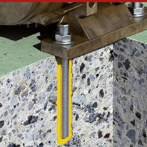
Pâte à deux composants, à base de résines polyester, pour la réalisation rapide de fixations et d'ancrages structurels d'inserts et de connecteurs en général. Il s'agit d'une résine à prise rapide (elle durcit après seulement 6 minutes à 20 °C) qui permet d'utiliser des inserts métalliques après seulement 2 heures et demie d'installation.
