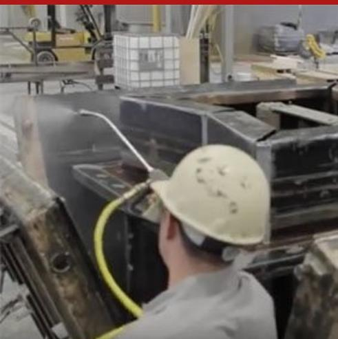
Décoffrant à base de composés organiques sélectionnés, promoteurs de détachement et agents d'anti corrosion, prêt à l'emploi, spécifique pour des coffrages métalliques. Distak-M doit être utilisé non dilué, vaporisé directement sur les surfaces à traiter.
