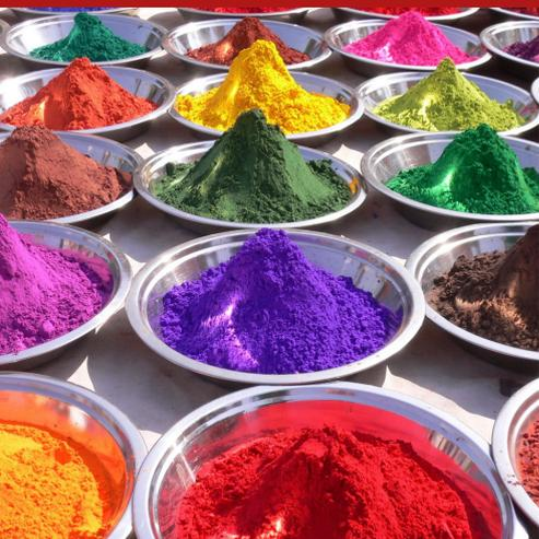
Protech Oxicrom est un composé en poudre, inorganique, qui se constitue principalement d'oxydes et oxy-hydroxydes de fer. Ajouté en quantités opportunes et distribué de façon homogène, il est idéal pour la pigmentation d'agglomérés en béton ou similaires, plâtres et peintures. Les oxydes Protech Oxicrom sont disponibles en jaune, rouge, marron, vert, bleu et noir.
